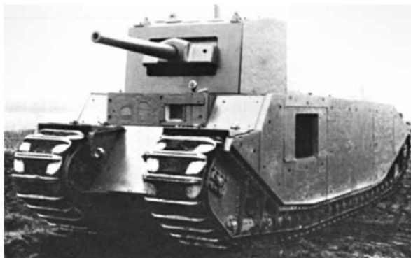
▼ TOG 2 met nieuwe rupsbanden en een nieuw ontworpen toren met daarin naar het schijnt een 76 mm kanon.
