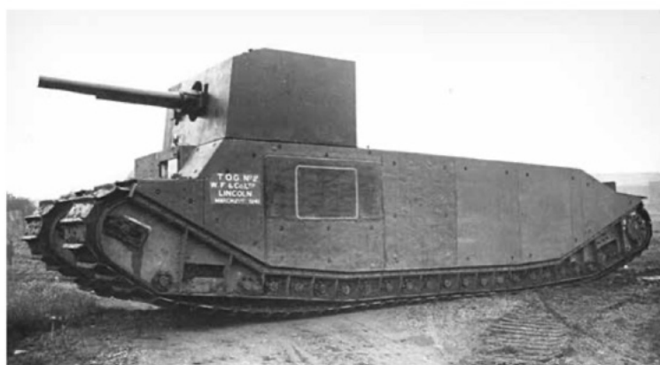
▲ TOG 2 heeft ook een enorme toren gehad met daarin een drieling affuit met een 76 mm kanon, een 2-ponder kanon en een Besa mitrailleur.
